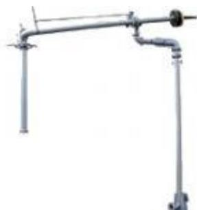
Устройство УНЖ 100 АС предназначено для переливания светлых нефтепродуктов в ж/д цистерны. УНЖ-100 АС состоит из вертикальной стойки, закрепленной основанием к фундаменту и соединенной внизу с заслонкой с электроприводом, а вверху при помощи болтовых соединений – к опорному шарниру.
