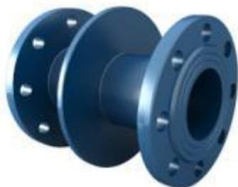
Патрубок приемо-раздаточный ППР предназначен для соединения резервуаров для нефтепродуктов с технологическими трубопроводами, запорной арматурой, хлопушками и другим резервуарным оборудованием. Монтаж осуществляется в стенке резервуара в нижнем поясе.
