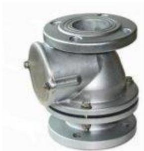
Клапаны дыхательные закрытого типа КДЗТ предназначены для герметизации газового пространства резервуаров со светлыми нефтепродуктами и поддержания давления в этом пространстве в заданных пределах с целью сокращения потерь от испарения и уменьшения загрязнения окружающей среды их парами.
