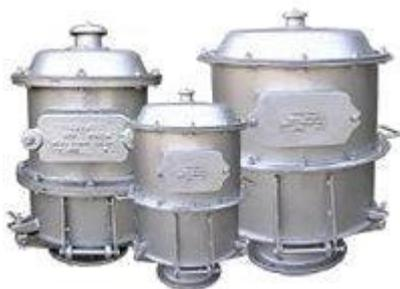
Клапан дыхательный НДКМ непримерзающий мембранный используется в качестве дыхательного оборудования на резервуарах с нефтепродуктами с допустимым избыточным давлением 200 мм вод. ст. и сообщающего газовое пространство резервуара с атмосферой.
