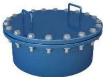
Люк световой ЛЩП-500 с поворотным устройством предназначен для проветривания резервуара перед проведением осмотра и ремонта, монтируется на щитовой крыше резервуара над приемо-раздаточным патрубком.
