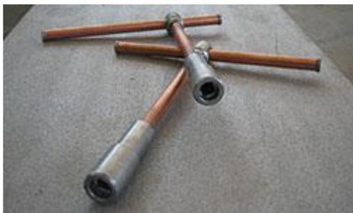
Ключ задвижки донной КЗД применяется для открывания донной задвижки нижнего слива железнодорожных нефтебензиновых вагонов-цистерн. Ключ относится к группе искробезопасных инструментов.
