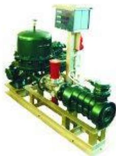
Автоматическая система налива нефтепродуктов представляет с собой единый автоматизированный комплекс узлов и агрегатов, используемых для дозированного налива горючего в железнодорожные цистерны, автотопливозаправщики, резервуарный парк, наливные суда. Автоматизированная система налива нефтепродуктов состоит из трех узлов: раздаточного, механического и управления.
