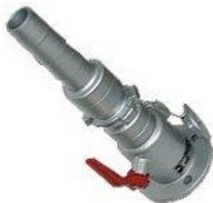
Узел рециркуляции паров УПР-50 используется для герметизации линии рециркуляции автоцистерны и резервуаров с нефтепродуктами, обеспечивает рециркуляцию топливных паров по замкнутому контуру при сливе и наливке нефтепродуктов, не допуская их выход в атмосферу.
