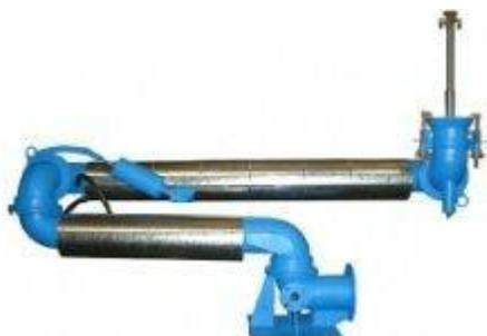
Установка УСН 175 ГП-263 предназначено для перелива нефтепродуктов из ж/д цистерн. Шарнирный трубопровод УСН 175 ГП-263 оснащен подогревающей рубашкой, присоединительной головкой и опорным патрубком. Установка имеет напорный трубопровод и телескопический гидромонитор с сопловой головкой. Герметичное соединение УСН 175 ГП-263 с цистерной обеспечивается особой формой уплотнения головки и независимой конструкцией захватов.
