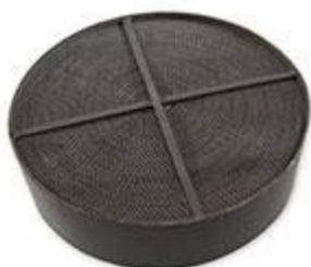
Кассета КО является пламягасящим сменным элементом огнепреградителя. Кассета огнепреградителя КО предназначена для комплектования огнепреградителей ОП-ААН, клапанов дыхательных КДС, клапанов предохранительных гидравлических КПГ, клапанов непрмерзающих дыхательных мембранных НДКМ \* с целью временного предотвращения проникновения пламени внутрь резервуара с нефтью и нефтепродуктами при воспламенении выходящих из него взрывоопасных смесей газов и паров с воздухом.
