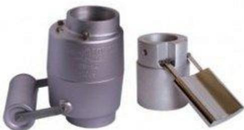
Ограничитель налива ОН-80А и клапан отсечной поплавковый ОК-80 используются для перекрытия потока нефтепродуктов во время слива из автоцистерны в резервуар АЗС по достижению уровня нефтепродуктов в резервуаре заданной величины (для клапана отсечного поплавкового ОК-80 — 95% объема резервуара).
