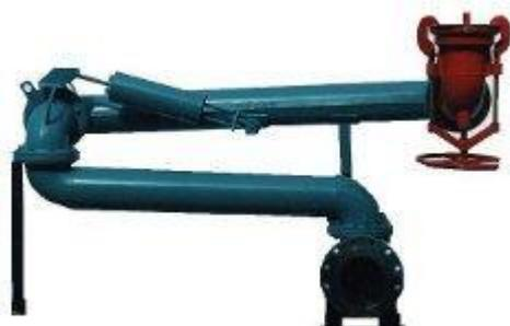
Установка УСН-150 ХЛ-6м предназначена для слива нефтепродуктов и нефти из вагонов-цистерн, имеющих универсальные сливные устройства. УСН-150 ХЛ-6м изготовлена из труб, соединенных шарнирами, на одном конце которых расположена присоединительная головка, а на другом — опорный патрубок с присоединительным фланцем.
