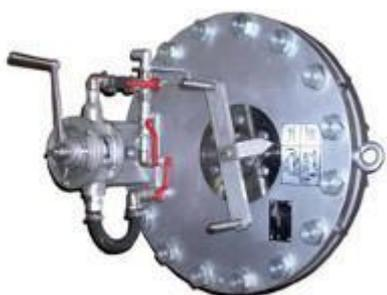
ПСПР используется для отбора проб нефтепродуктов по всей высоте вертикальных цилиндрических резервуаров. Полученная при помощи пробоотборника ПСПР проба по своему химическому составу точно соответствует нефтепродукту на всех уровнях резервуара. Перед отбором пробы отстоявшийся в трубопроводе нефтепродукт закачивается обратно в резервуар, что исключает потери нефтепродукта и загрязнение окружающей среды.
