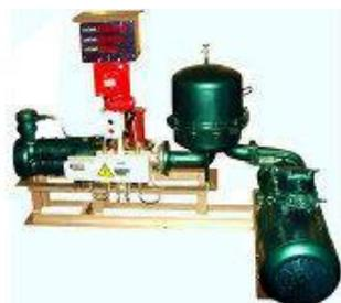
Автоматизированная система налива АСН-Д-100 представляет собой комплекс агрегатов и узлов, необходимых для дозированного налива топлива в автотопливозаправщики, железнодорожные цистерны, резервуарный парк, наливные суда.
