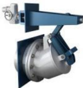
Хлопушка электроприводная ЭХ-700 используется для предотвращения потери нефтепродуктов во время налива из-за выхода из строя запорных устройств или разрыва трубопровода. Хлопушка монтируется на приемо-раздаточном патрубке, обращенном внутрь резервуара.
