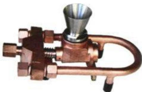
Захват ЗВ-18 используется для прямого подсоединения гибкого рукава к угловому вентилю ж/д цистерны при сливе и наливе сжиженных углеводородных газов. Захваты изготавливаются в двух исполнениях: ЗВ-18м — из конструкционной стали, с медным покрытием, ЗВ-18н — из нержавеющей стали.
