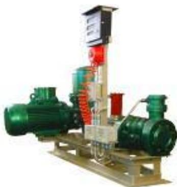
Система налива АСН-Д100К3 стандартного исполнения предназначена для осуществления дозированного налива жидких продуктов нефтехимии вязкостью от 0,55 до 300мм<sup>2</sup>/с при температуре от -50 до + 500°С в автомобильный, железнодорожный и морской транспорт, а так же внутри складские перекачки заданного объема с целью точного фиксированного заполнения ёмкостей и для компаундирования.
