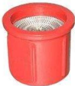
Пламяпреградитель ПП используется для временного предотвращения проникновения пламени внутрь резервуаров с нефтью и нефтепродуктами при воспламенении выходящих из него взрывоопасных смесей газов и паров с воздухом. Пламяпреградитель устанавливается между резервуаром и дыхательным клапаном.
