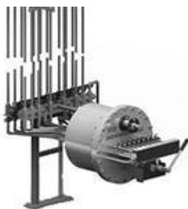
Пробоотборник стационарный резервуарный органного типа ПСР ОТ предназначен для отбора проб нефтепродуктов по всей высоте наземных резервуаров с нормальным и повышенным давлением. Пробоотборник ПСР ОТ является комплектующим изделием вертикальных цилиндрических резервуаров и устанавливается внутри них.
