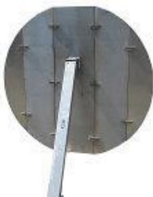
Диск отражатель ОТР предназначен для уменьшения потерь нефтепродуктов при сбросе дыхательными клапанами избыточного давления в резервуарах с нефтью и нефтепродуктами. Принцип действия диска отражателя ОТР заключается в препятствии распространению вглубь газового пространства входящей в резервуар струи воздуха.
