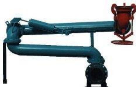
Устройство УСН-175, УСН-150 используется для нижнего слива нефтепродуктов из ж/д цистерн. УСН-175, УСН-150 представляют из себя шарнирный трубопровод с присоединительной головкой и опорным патрубком. Двухрядные шарниры позволяют легко перемещать установку, избегая перекосов при продолжительной эксплуатации.
