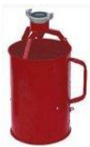
Генератор пены ГПС 200, ГПС 600, ГПС 2000 (пеногенератор ГПС) предназначен для выработки из водного раствора пенообразователя воздушно-механической пены средней кратности. Подача пены: 200, 600 и 2000 л/с соответственно. ГПС представляет собой водоструйный аппарат переносного типа, который состоит из: кассеты, сеток, ремня и корпуса. К последнему при помощи четырех винтов крепится корпус распылителя, а также соединительная головка.
