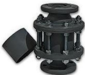
Предохранитель огневой коммуникационный (огнепреградитель) ПОК предназначен для установки на газо- и нефтепроводах, работающих при давлении до 1,6 МПа (16 кгс/см<sup>2</sup>) с целью предотвращения распространения пламени по трубопроводу в случае его возникновения.
