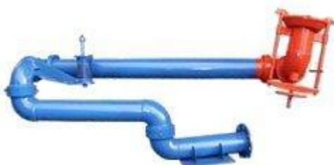
Установка УСН-150 ХЛ-1 предназначена для нижнего слива нефтепродуктов и нефти из ж/д цистерны с универсальными приборами для слива. УСН-150 ХЛ-1 изготовлена из труб, соединенных шарнирами, и имеющими на одном конце присоединительную головку, а на другом — опорный патрубок и присоединительный фланец.
