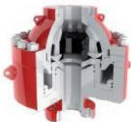
Превентор универсальный сферический ПУС применяется для герметизации устья нефтегазовой скважины при бурении, с наличием или отсутствием колонны буровых труб, а также при протаскивании труб под давлением. Превентор ПУС препятствует выбросу и фонтанированию добываемого сырья в окружающую среду.
