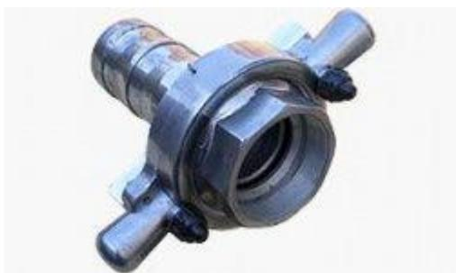
Муфта сливная МСМ с ниппелем используется для герметичного соединения приемной трубы подземного резервуара к сливному рукаву автоцистерны при сливе нефтепродуктов. Муфта МСМ устанавливается на приемный патрубок или сливной фильтр с уплотнителем, ниппель закрепляется на манжете напорно-всасывающего рукава автоцистерны. Рукав закрепляется при помощи хомутов.
