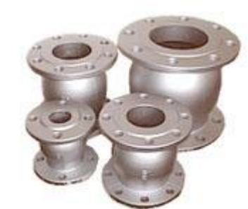
Клапаны обратные ЗКО используются для отсекаания обратного потока среды при прекращении подачи нефтепродукта. Устанавливаются на наливных устройствах нефтехранилищ и АЗС. Рабочее давление от 1 МПа (10 кгс/см<sup>2</sup>) до 4 МПа (40 кгс/см<sup>2</sup>).
