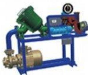
Комплекс СДК-01, счетно-дозировующий, предназначен для измерения объема, а также коммерческого отпуска заданного количества нефтепродуктов при наливе, сливе, перекачке. СДК-01 обеспечивает перекачку нефтепродуктов в автоцистерны, железнодорожные цистерны или другие емкости.
