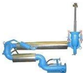
Установка УСН-175 ГП используется для нижнего слива нефтепродуктов из ж/д цистерн. УСН-175 ГП представляет собой шарнирный трубопровод с опорным патрубком, подогревающей рубашкой и присоединительной головкой, оснащен телескопическим гидромонитором и напорным внутренним трубопроводом.
