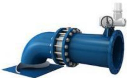
Приемо-раздаточное устройство ПРУ предназначено для закачки и откачки нефти и нефтепродуктов в резервуар и предотвращения утечки нефтепродукта через неплотности в приемо-раздаточном трубопроводе и в резервуарной задвижке во время ее закрытия. Может устанавливаться в резервуары в качестве замены хлопушек.
