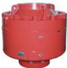
Превентор универсальный гидравлический ПУГ герметизирует устье скважины при наличии или отсутствии в ней бурильных труб, обеспечивая герметичность нефтегазовой скважины при вращении колонны труб и протаскивании их вместе с муфтами и замками.
