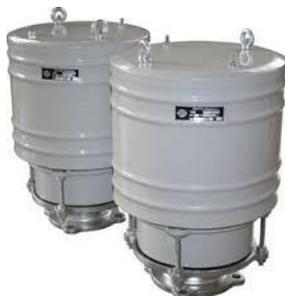
Клапаны дыхательные механические КДМ -200 предназначены для герметизации газового пространства резервуаров со светлыми нефтепродуктами и поддержания давления в этом пространстве в заданных пределах с целью сокращения потерь от испарения и уменьшения загрязнения окружающей среды их парами.
