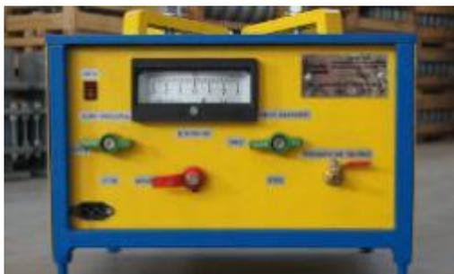
Основным назначением стенда является проверка клапана дыхательного на герметичность, а также его настройка на вакуум и давление срабатывания. На стенде могут проверяться дыхательные клапаны КДМ, НДКМ, КДС, СМДК и другие с условным проходом DN от 50 до 500 мм.
