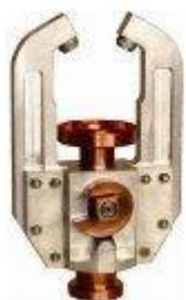
Захват ЗК-18 используется для прямого подсоединения гибкого рукава к угловому вентилю ж/д цистерны при сливе и наливе сжиженных углеводородных газов. Захваты ЗК-18 изготавливаются в двух исполнениях: ЗК-18м — из конструкционной стали, с медным покрытием, ЗК-18н — из нержавеющей стали.
