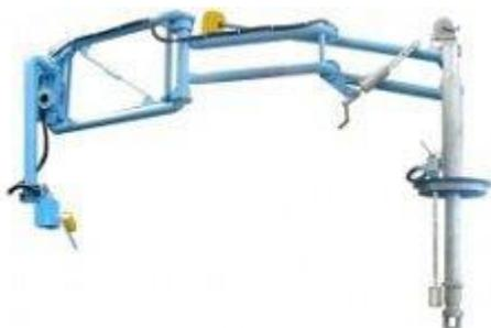
Устройство используется для верхнего налива нефтепродуктов и нефти с соблюдением герметичности в железнодорожные цистерны с выводом паров из зоны налива. Пары отводятся через герметичный шарнирный трубопровод, не нуждающийся в замене в течение срока службы УНЖ6-100.
