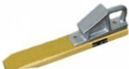
Башмак железнодорожный искробезопасный противооткатный БК-1 предназначен для препятствия самопроизвольному перемещению железнодорожного транспорта. Башмак БК-1, будучи выполненным из цветного металла (латунь ЛК-80), не вызывает искры, что позволяет использовать его на объектах с повышенными требованиями к искробезопасности. БК-1 устанавливают на рельс после остановки транспортного средства.
