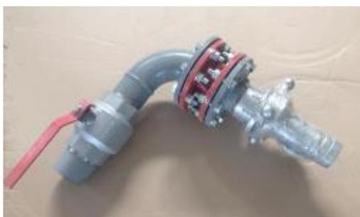
Сливное устройство (устройство слива нефтепродуктов) УС 80-А, УС-80 А-135 применяется для слива дизельного топлива и бензина в резервуар АЗС из автоцистерны. Устройства применяются для оснащения АЗС, в том числе и в системе «резервуар-автоцистерна».
