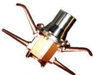
Захват мембранный ЗМ-1 используется для подсоединения гибкого рукава к прямому вентилю ж/д цистерны при сливе и наливе сжиженных углеводородных газов. Изготавливается в двух исполнениях: ЗМ-1м — из конструкционной стали, с медным покрытием, ЗМ-1н — из нержавеющей стали.
