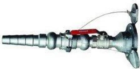
Узел рециркуляции паров УПР-40 АЦ необходим для обеспечения герметичности соединения линий рециркуляции резервуара к цистерне. Узел служит для перемещения топливных паров по замкнутому контуру, не допуская их выброс в атмосферу при сливе и наливке нефтепродуктов.
