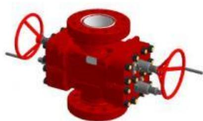
Превентор плащечный сдвоенный ППС предназначен для герметизации устья нефтегазовой скважины на время текущего или капитального ремонта скважин, а также геофизических работ. Превентор ППС обеспечивает безопасное ведение работ, препятствует выбросу и фонтанированию добываемого сырья в окружающую среду.
