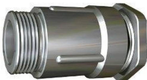
Соединитель пластикового трубопровода ДУ используется для герметизации присоединения пластикового трубопровода к различным устройствам линии выдачи резервуарного парка АЗС и нефтехранилищ. Рабочий диапазон температур от  $-50^{\circ}\text{C}$  до  $+50^{\circ}\text{C}$ .
