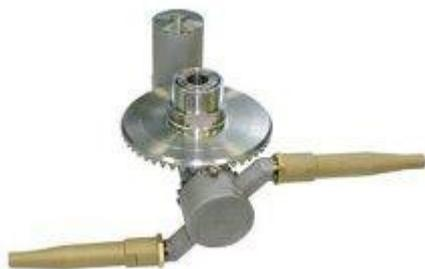
Промывочная головка используется для очистки внутренней поверхности ж/д цистерн при помощи горячей воды, подаваемой под давлением. При помощи съемного приспособления головка легко монтируется в верхнем наливном люке цистерны. Конструкция промывочной головки позволяет очищать цистерну и емкости от остатков нефтепродуктов, химических и пищевых продуктов.
