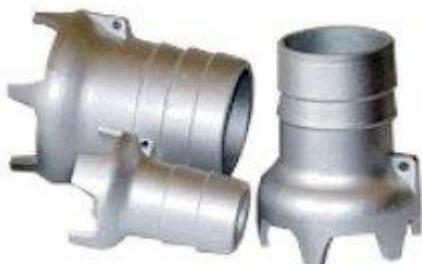
Наконечник НК «Корона» используется для очистки дна резервуаров на АЗС и нефтехранилищах. Наконечник устанавливается в заборный рукав. Во время чистки к наконечнику за проушину прикрепляется страховочный тросик, одновременно выполняющий функцию заземления.
