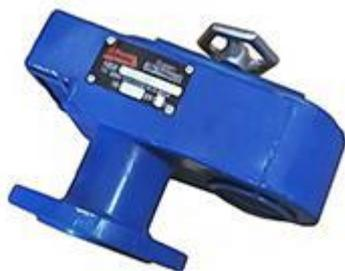
Клапан дыхательный механический КДМ-50 со встроенным огнепреградителем предназначен для герметизации газового пространства резервуаров со светлыми нефтепродуктами и регулирования давления в этом пространстве в заданных пределах, с целью сокращения потерь от испарения нефтепродуктов и уменьшения загрязнения окружающей среды.
