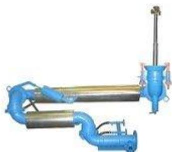
Установка УСН-175 Г используется для переливания нефтепродуктов из ж/д цистерн. УСН-175 Г представляет собой шарнирный трубопровод с присоединительной головкой и опорным патрубком, оснащенный напорным внутренним трубопроводом и телескопическим гидромонитором.
