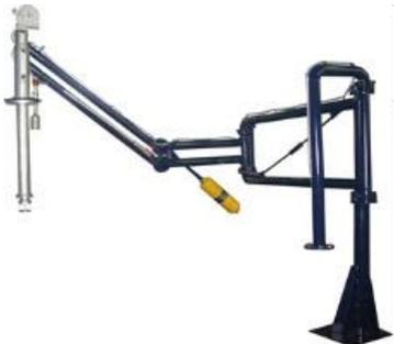
Автоматизированная система налива АСН-Д-100 может работать с любыми устройствами верхнего (АСН) и нижнего (УННА) налива. Устройство АСН-Д-100 предназначено для герметизированного верхнего налива нефти и нефтепродуктов в автомобильные цистерны с отводом
