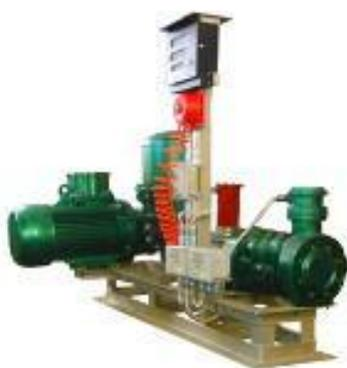
Система налива АСН-Д100К3 стандартного исполнения предназначена для осуществления дозированного налива жидких продуктов нефтехимии вязкостью от 0,55 до 300мм<sup>2</sup>/с при температуре от -50 до + 500°С в автомобильный, железнодорожный и морской транспорт, а так же внутри складские перекачки заданного объема с целью точного фиксированного заполнения ёмкостей и для компаундирования. АСН-Д100К3 применяется в стационарных и передвижных
