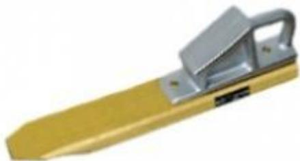
Башмак железнодорожный искробезопасный противооткатный БК-1 предназначен для препятствия самопроизвольному перемещению железнодорожного транспорта. Башмак БК-1, будучи выполненным из цветного металла (латунь ЛК-80), не вызывает искры, что позволяет использовать его на объектах с повышенными требованиями к искробезопасности. БК-1 устанавливают
