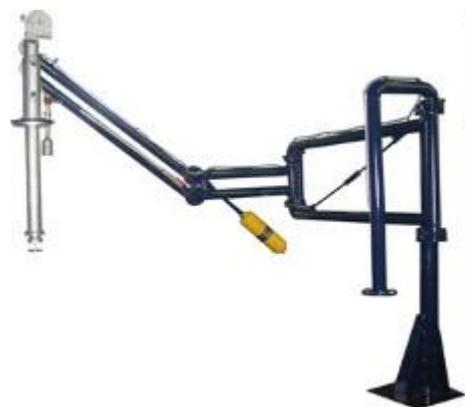
Устройство АСН-80-02 предназначено для герметизированного верхнего налива нефти и нефтепродуктов в автомобильные цистерны с отводом паров из зоны налива.
