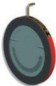
Разрывные предохранительные мембраны «Горгона» предназначены для использования в системах подслоного тушения пожаров для герметизации участка трубопровода, соединяющего резервуар с высоконапорным пеногенератором. Разрывные мембраны данных моделей могут эксплуатироваться как в наружных установках, так и в помещениях во взрывоопасных зонах класса 1 и 2 ГОСТ Р 51330.9, где возможно образование паро- и газозводушных смесей
