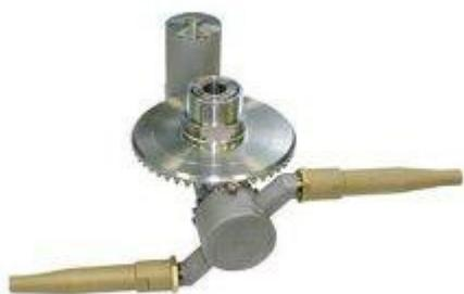
Промывочная головка используется для очистки внутренней поверхности жд цистерн при помощи горячей воды, подаваемой под давлением. При помощи съемного приспособления головка легко монтируется в верхнем наливном люке цистерны. Конструкция промывочной головки позволяет очищать цистерну и емкости от остатков нефтепродуктов, химических и пищевых продуктов. Головка выполнена целиком из коррозионностойких сталей, что делает ее устойчивой к
