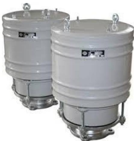
Клапаны дыхательные механические КДМ -200 предназначены для герметизации газового пространства резервуаров со светлыми нефтепродуктами и поддержания давления в этом пространстве в заданных пределах с целью сокращения потерь от испарения и уменьшения загрязнения окружающей среды их парами. В конструкцию КДМ-200 входит кассета огневого предохранителя. Клапаны КДМ-200 могут быть использованы как в качестве дыхательных, так и в качестве предохранительных клапанов.
